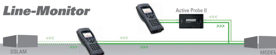
Echtzeit-Leitungsmonitor (bis zu 30 MHz) mit Umschaltung im Frequenz- und Zeitbereich, z. B. zur Detektion von Handshaketönen, Übersprechen oder temporären Störern. Mit Hilfe der Active Probe lässt sich zwischen symmetrisch und asymmetrisch umschalten und so das Nutzsignal ausblenden.
