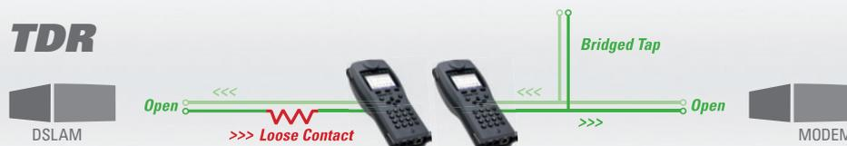
Zeitbereichsreflektometrie (TDR) zur Bestimmung von Leitungslängen und zur Lokalisierung von z. B. Stichleitungen oder schlechten Kontakten. Zudem lässt sich der Ausgangswiderstand\* des TDRs an den Wellenwiderstand der Leitung anpassen oder mit einem VoP vorkonfigurierte Kabeltypenlisten auswählen.
